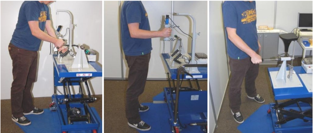
Abb. 2 ▲ Messpositionen (rechte Hand) für die 3 Kraftfälle links Zugkraft, Mitte Greifkraft und rechts Drehmoment am Schraubendreher
